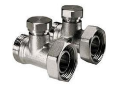
H - вентиль прямой 3/4" x 3/4" ЕК двухтрубный
